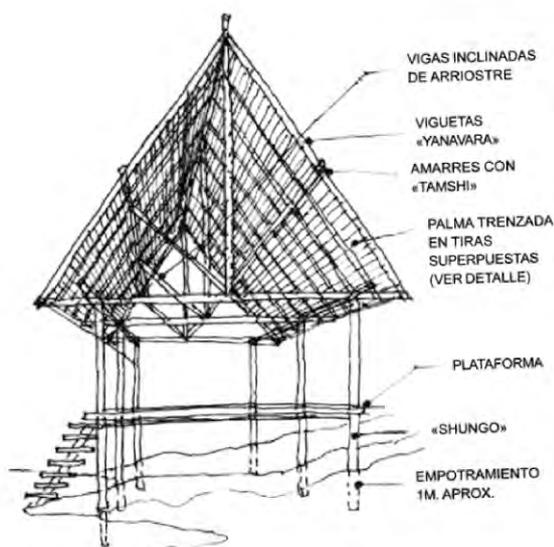
Figura 8: Sistema constructivo, estructura de troncos rollizos, techos de palma. (Burga, J., 2010)
